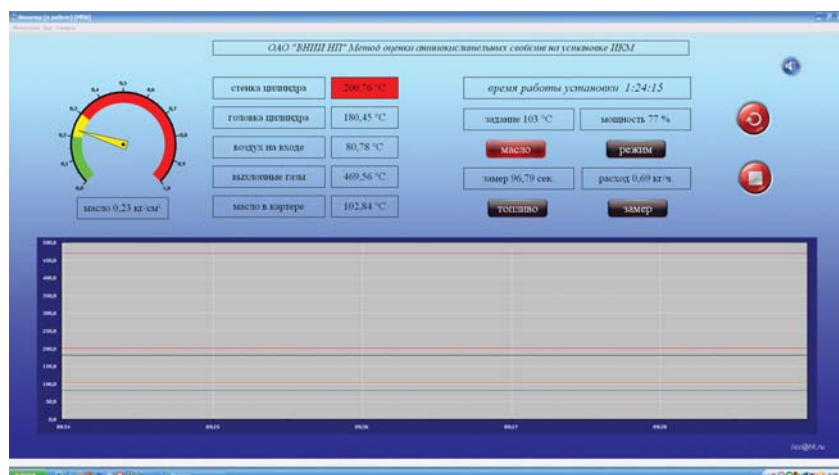
Рис. 2. Мнемосхема установки ИКМ (оценка окислительной стабильности масел)
